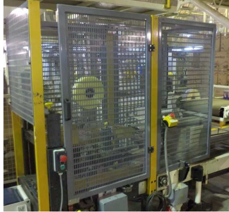
Imagen 24. Protecciones mecánicas en equipo encintadora
