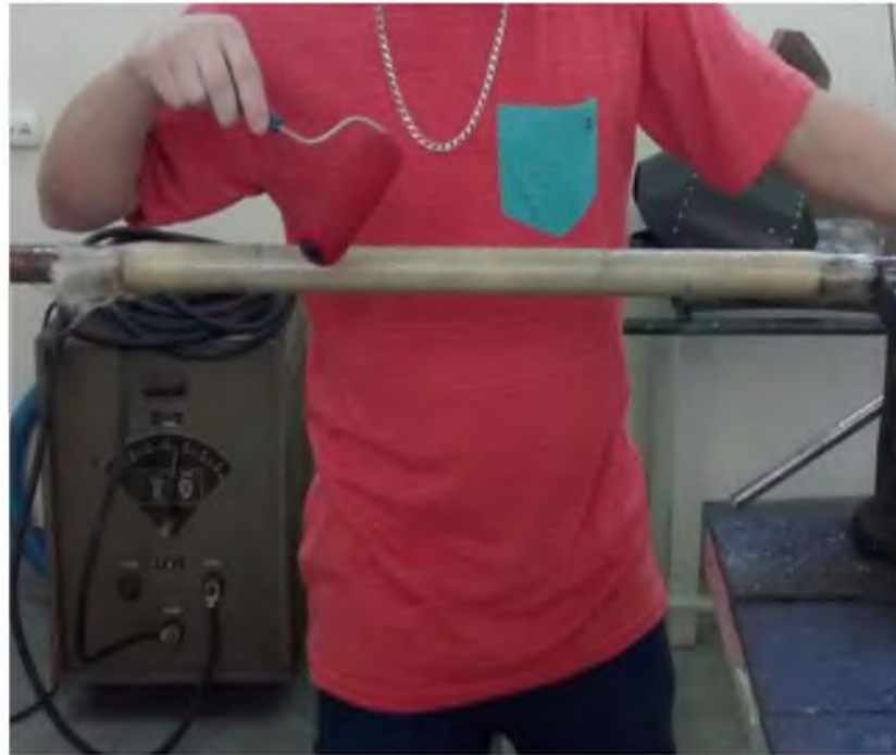
Fig. 47 Laminado sobre tubo de acero.
