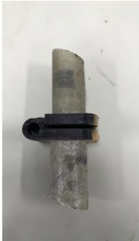
Fig. 51 . Ensayo de la vinculación de pliegue
