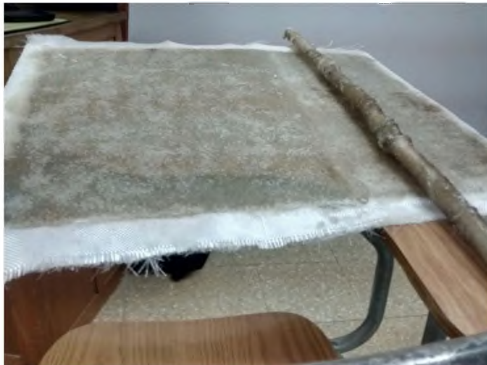
Fig. 46 Práctica de laminado en plano y resultado de laminado de manguera.
