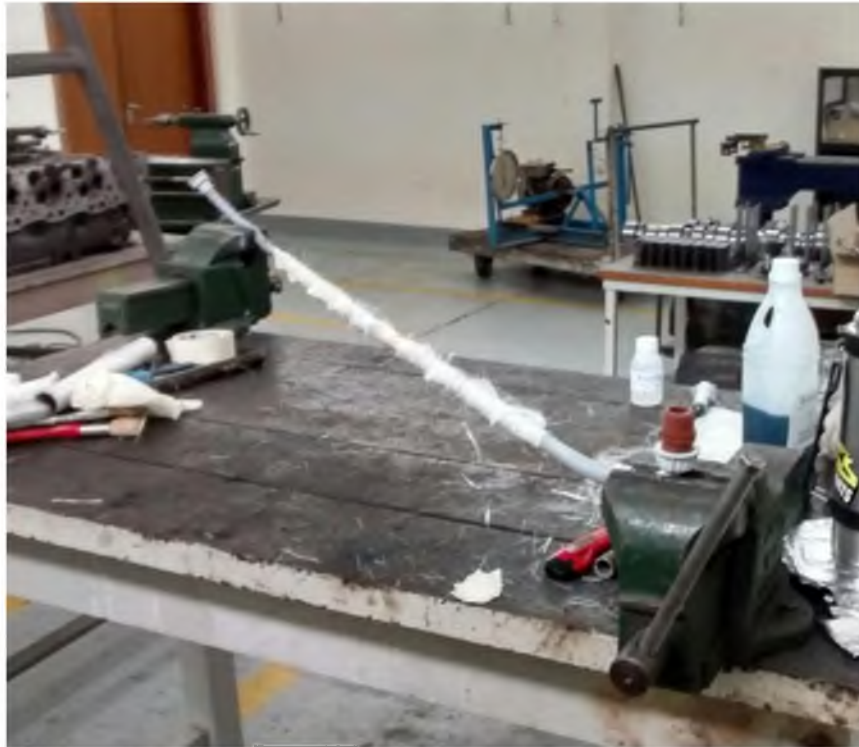
Fig. 45 Laminado sobre una manguera para lograr una forma curva (Rechazado).
