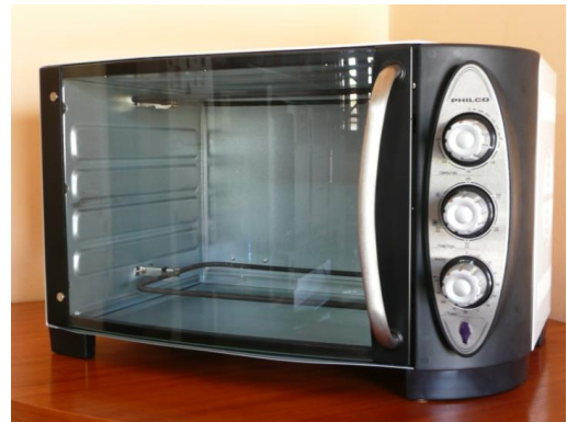
Figura 4. Horno eléctrico de convección forzada Philco que se utilizó en el secado.
