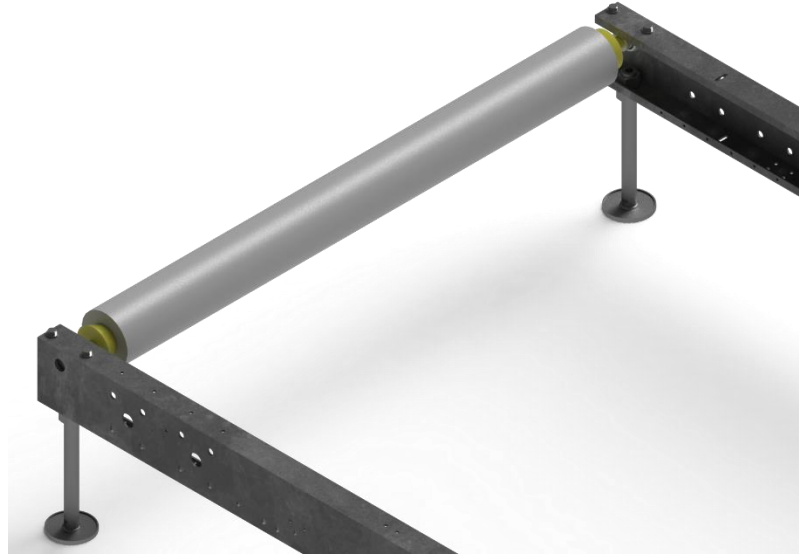
Figura 5.5 Sistema de abastecimiento montado sobre el bastidor
