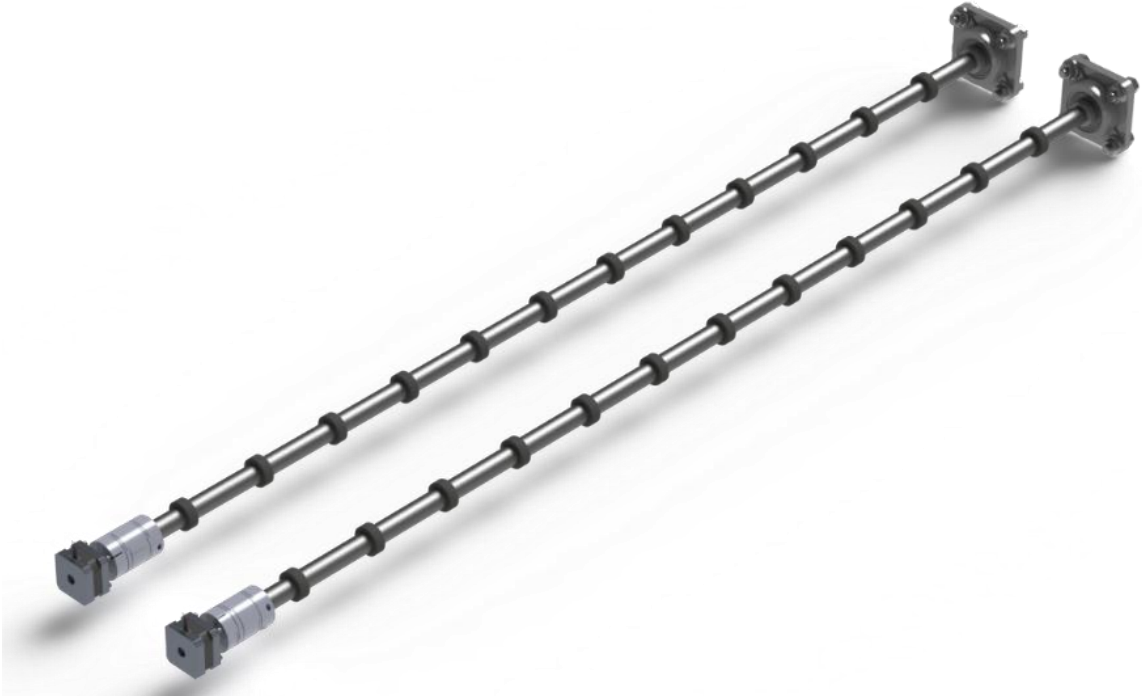
Figura 5.31 Sistema de traslación
