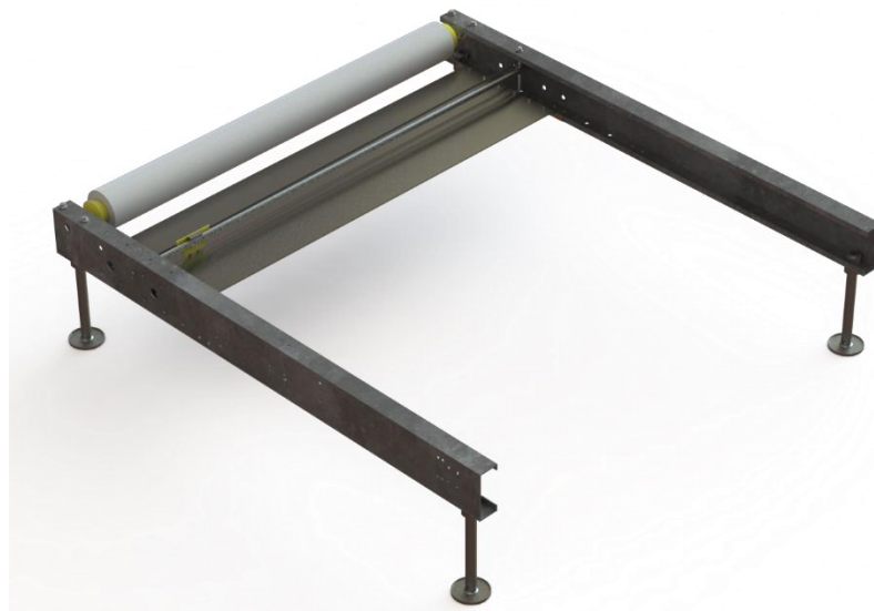
Figura 5.12 Sistema guillotina montado sobre el bastidor
