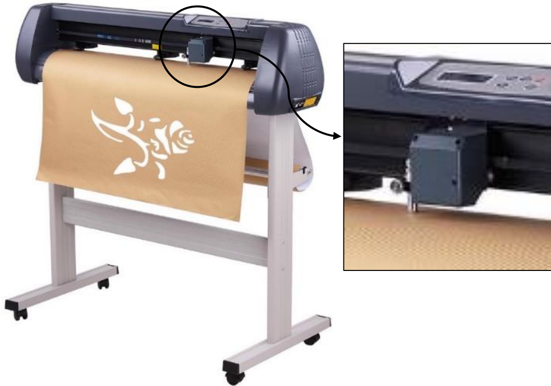
Figura 4.9 Izquierda, plotter de corte. Derecha, carro porta cúter
