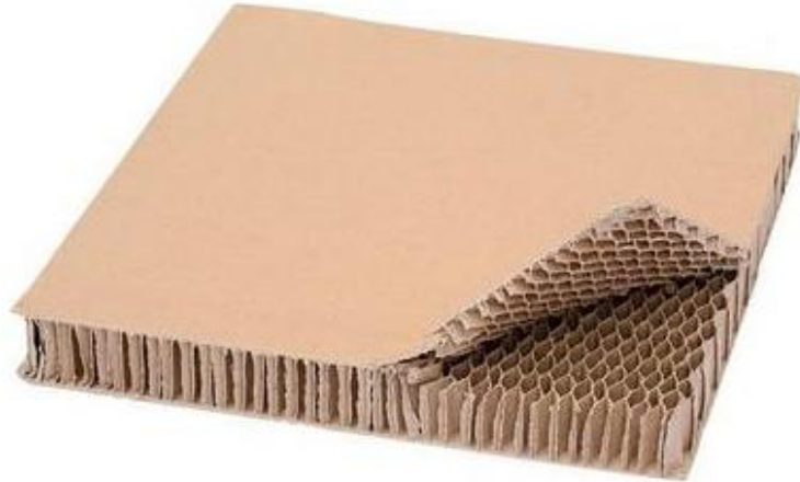
Figura 3.3 Panel honeycomb de cartón. En una esquina la tapa fue desgarrada para mostrar las columnas hexagonales de su interior
