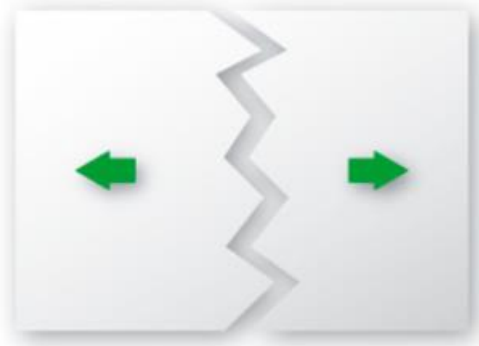
Figura 5.49 Consecuencias de tensión excesiva en el papel
