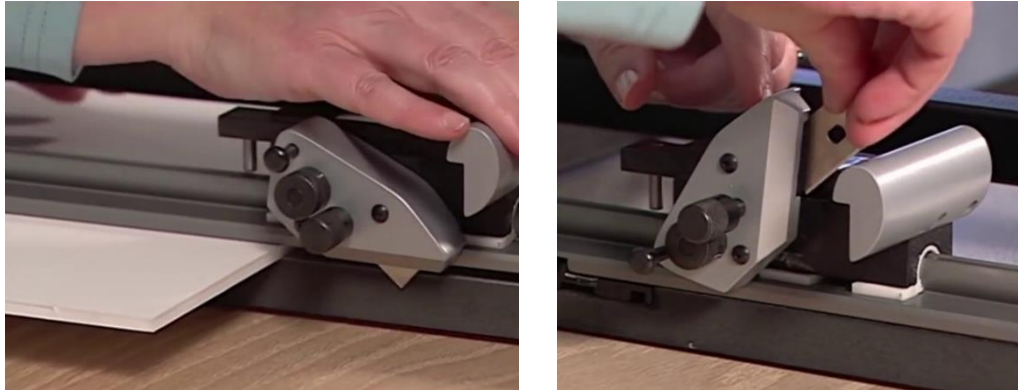
Figura 4.8 Guillotina manual de carro y guía. Izquierda, usuario comenzando la traslación del carro para efectuar el corte. Derecha, usuario realizando el cambio de herramienta de corte desgastado
