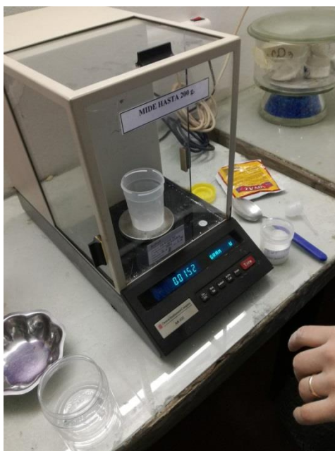
FIGURA N°6: Se pesó con balanza analítica el BHT, lecitina de soja y el polvo de hornear.
