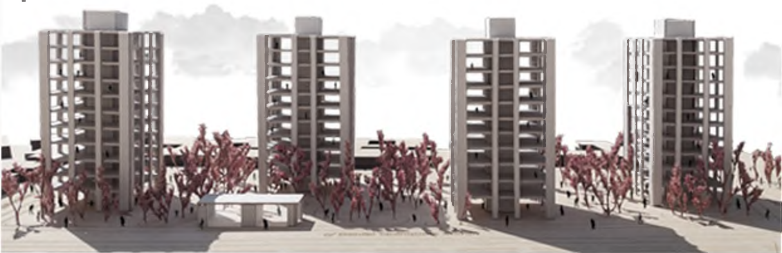
Estructura perimetral con tabiques de hormigón visto
