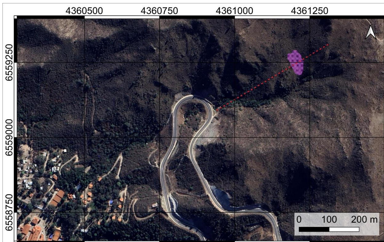
Figura 90. Deslizamiento. Violeta: ubicación del deslizamiento; rojo: trazado del perfil transversal.
