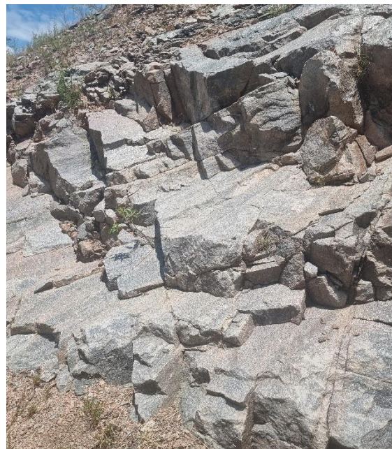
Figura 53. Detalle de los gneises con distancia entre la esquistosidad aproximada de 50 (cm).
