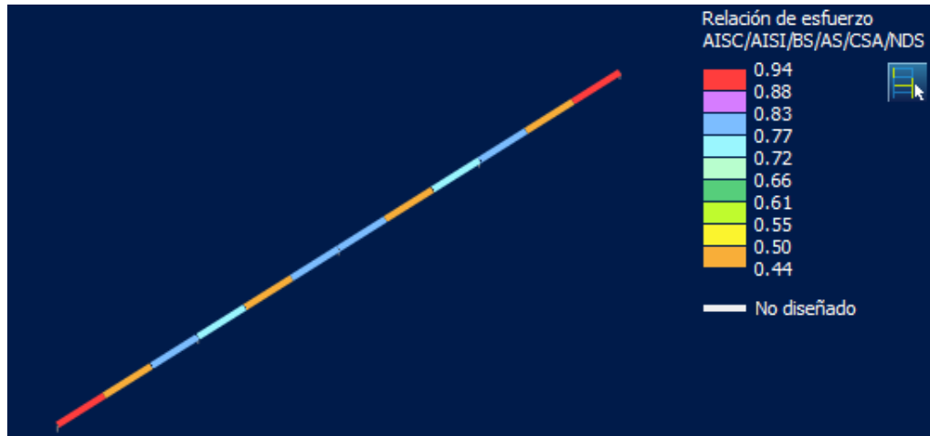
Imagen 164 - Relación máxima de esfuerzos de las correas para cocheras de camiones
