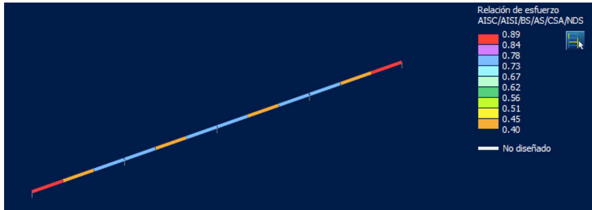
Imagen 134 - Relación máxima de esfuerzos de las correas para cocheras de autos
