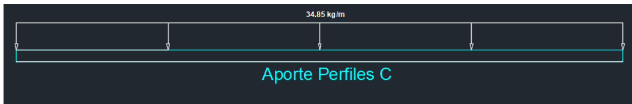
Figura IX-13 – Carga distribuida que aportan los perfiles C.
