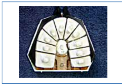
Fig. 17. Patrones y bebederos sobre modelo de revestimiento.
