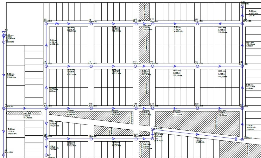
*Figura N° 13-3 Red de Agua Potable*
