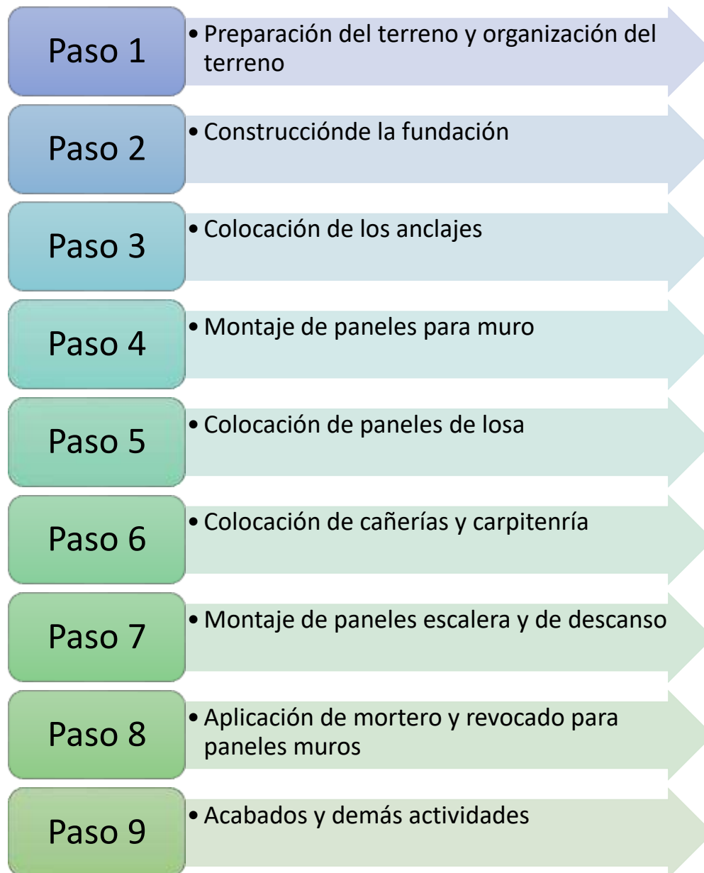
Figura 3. Diagrama de proceso constructivo del sistema EMMEDUE.
