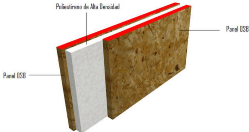
Conformación de un panel SIP.
