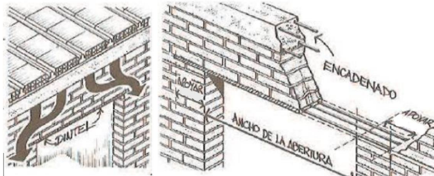
Figura 3.1.5.1-1 - Refuerzo de dintel (Nisnovich, 2018)
