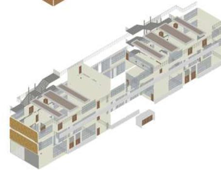
La **estructura** independiente y pre fabricada del edificio nos permite agilizar el tiempo de construcción, todos los elementos estructurales son de catálogo (industrial nacional), Es ensamblada insitu para el posterior trabajo de cerramientos.
