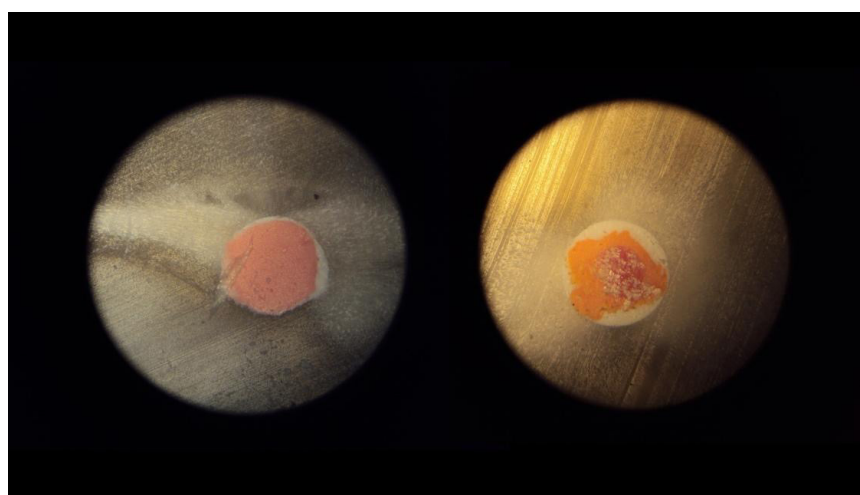
Figura 10: Ejemplos de secciones, previamente a realizar la prueba de push-out
