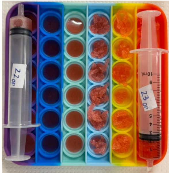
Figura 13. Representación de impresos extruidos con tinta de glicero – gelatina, sobre popit.
