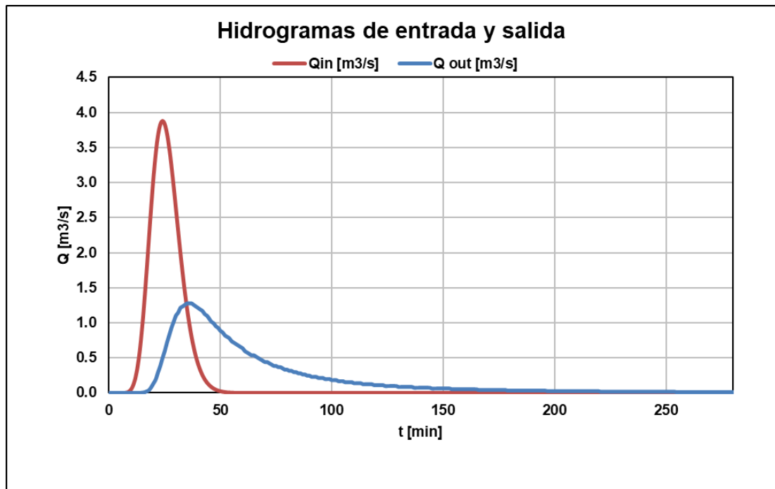
Figura 6.11 - Hidrogramas de entrada y salida de la laguna para TR = 5 años
