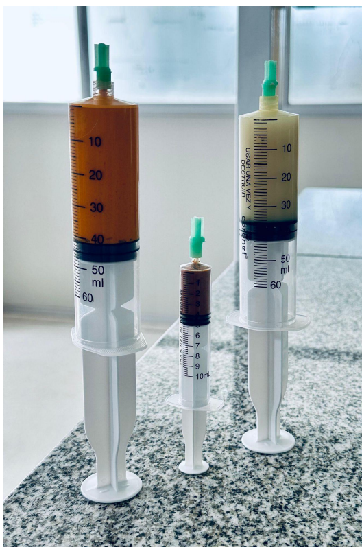
Figura 2. Jeringas prellenadas con las formulaciones obtenidas, listas para la extrusión mediante impresión 3D.
