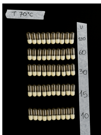
Figura 9. Uniformidad de peso del magnesio en función de la velocidad de extrusión a 70°C
