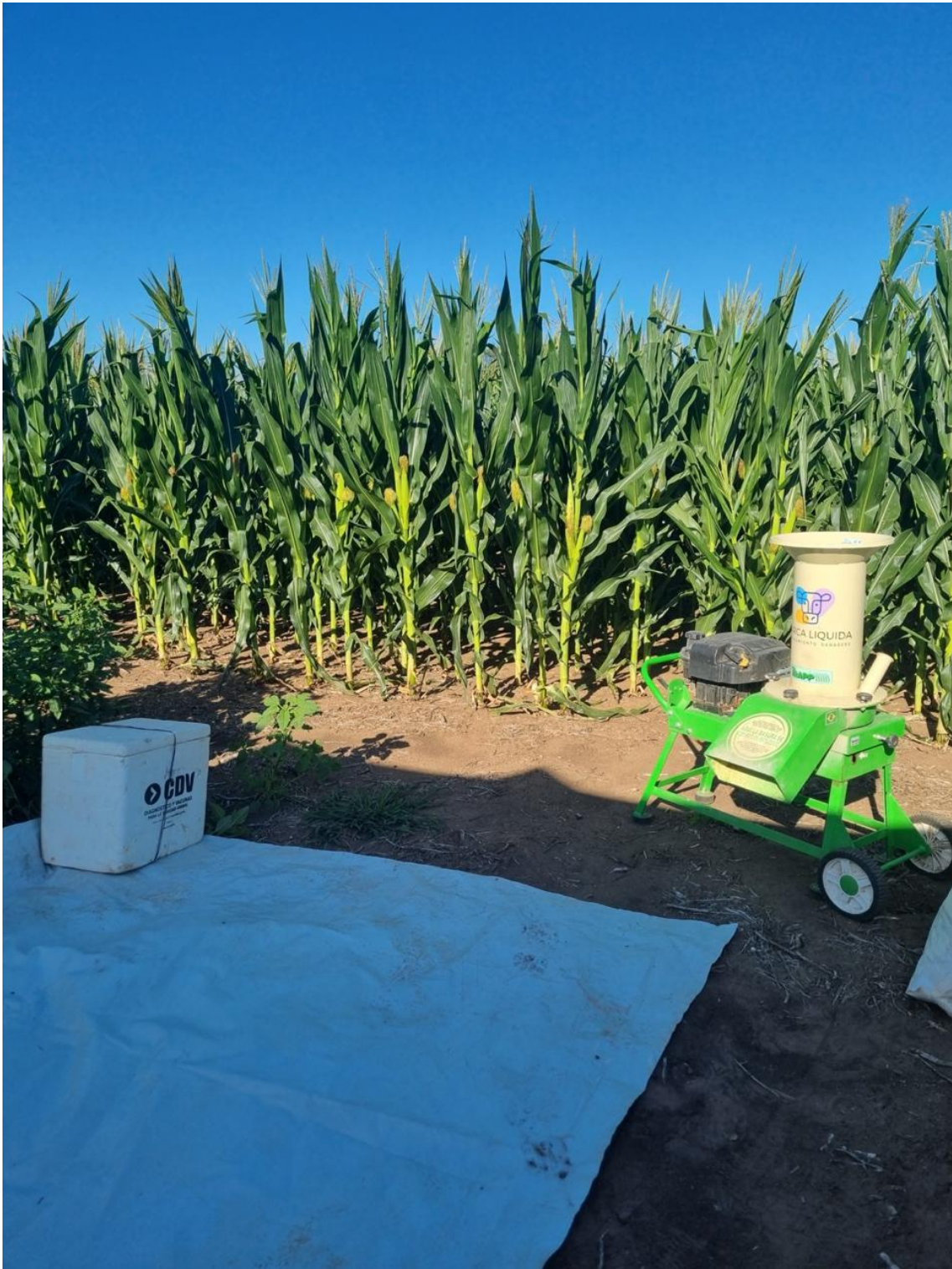
Figura 6 Estación de chipecado : Máquina chipecadora, lona y conservadora
