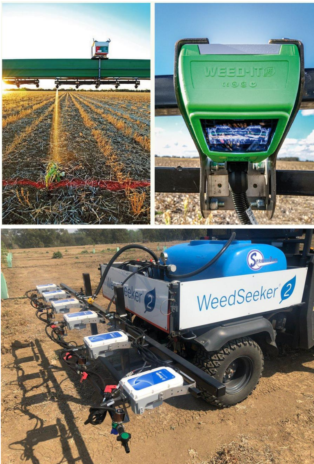
Figura 6: Sistemas de pulverización selectiva con mayor desarrollo y presencia comercial en la Argentina: arriba: WEED-IT; abajo: WeedSeeker.
