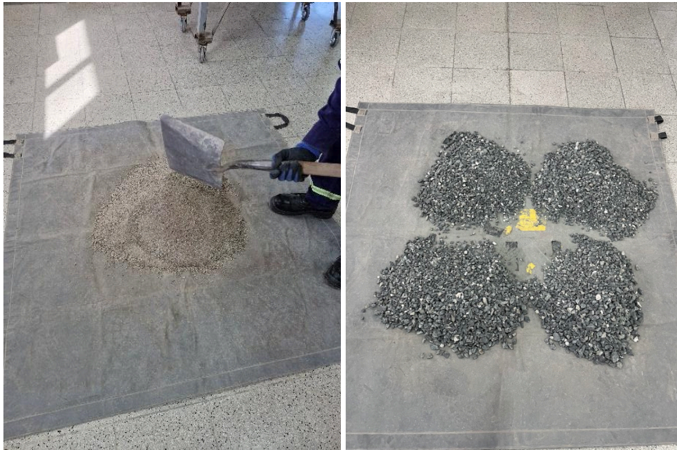
Ilustración 30 - Preparación y cuarteo
