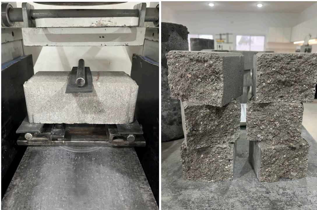
Ilustración 63 - Rotura a flexión (izq) - Adoquines Partidos (der)
