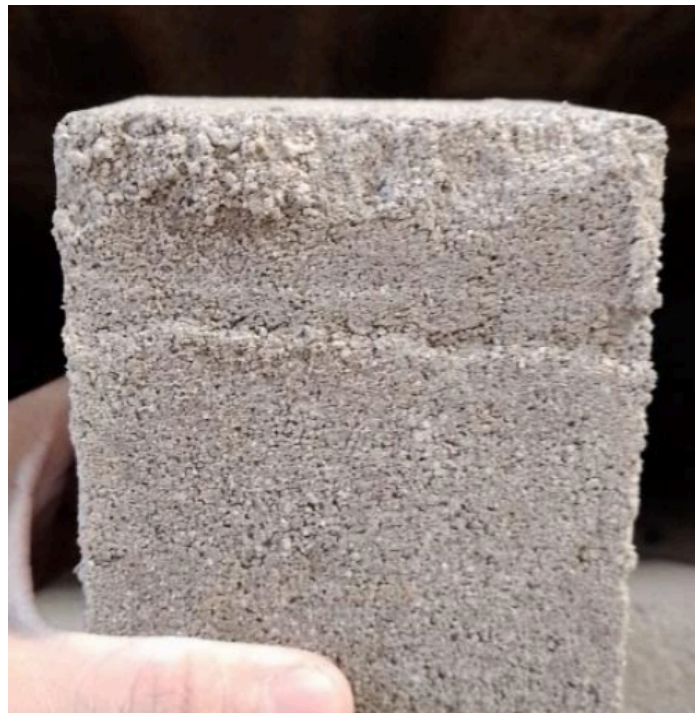
Ilustración 58 - Defecto en base
