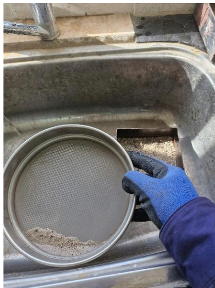
Ilustración 45 - Lavado sobre tamiz N. 200
