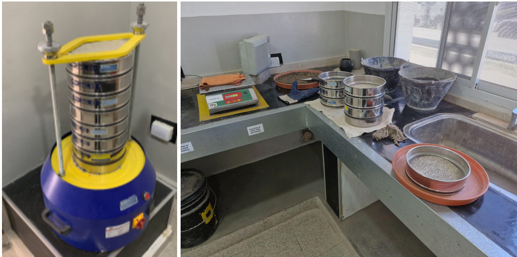
Ilustración 43 - Tamizadora para áridos finos y mesada de trabajo
