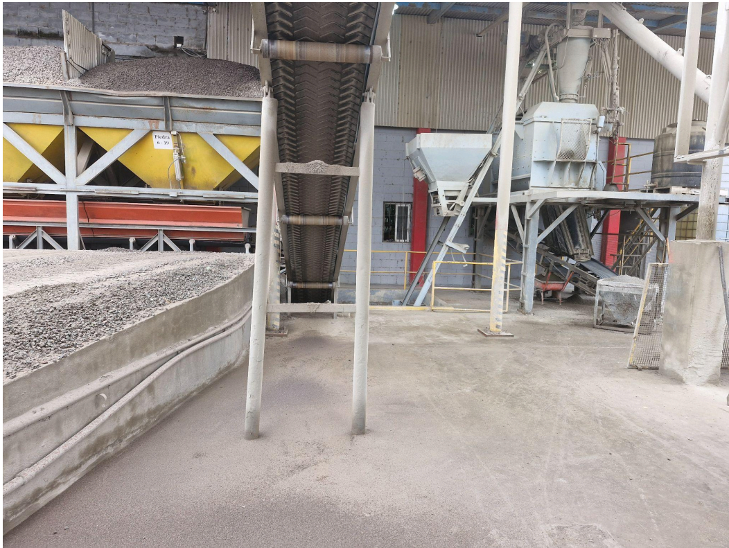
Ilustración 53 - Zona de tolvas, cangilón, báscula y mezcladora
