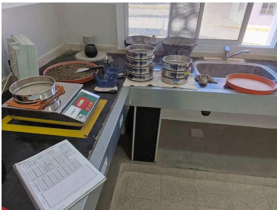
Ilustración 40 - Elaboración ensayo granulométrico
