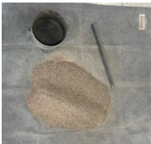
Ilustración 44 - Preparación ensayo PUV
