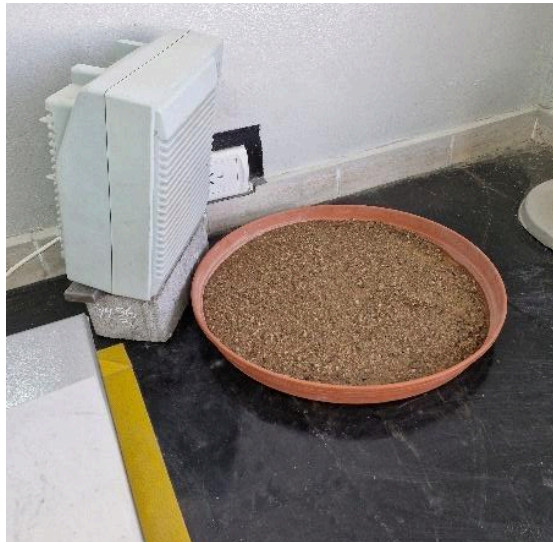
Ilustración 48 - Secado en caloventor para llevar a condición SSS
