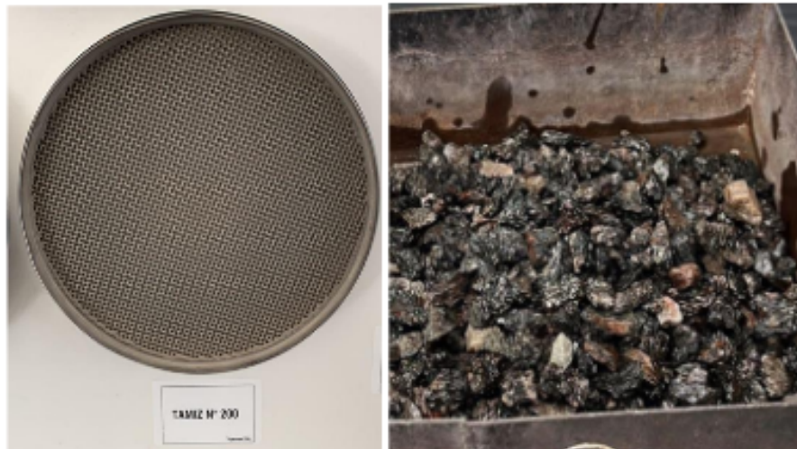
Ilustración 35 - Tamiz N. 200 y bandeja de trabajo
