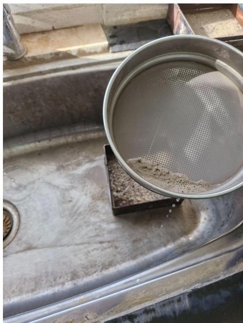
Ilustración 39 - Lavado sobre tamiz N. 200
