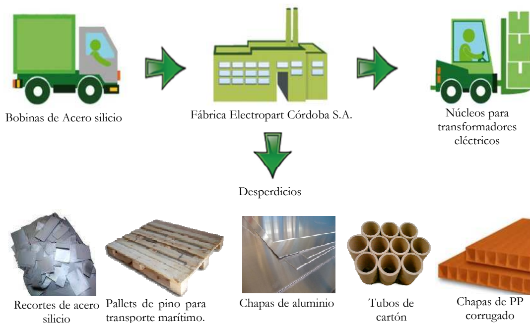
Figura 10. Esquema de generación de residuos en Electropart Córdoba S.A. Fuente elaboración propia
